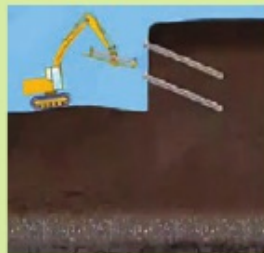
پایدارسازی شیب به روش میخ کوبی
