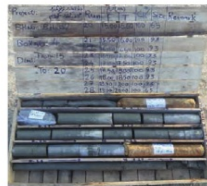
شکل ۳-۳ مغزه گیری توسط گمانه های اکتشافی
