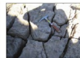
الف) توسعه درز و شکاف انحلالی در آهک
